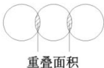
图一 同类桩截面有部分重叠示意图
