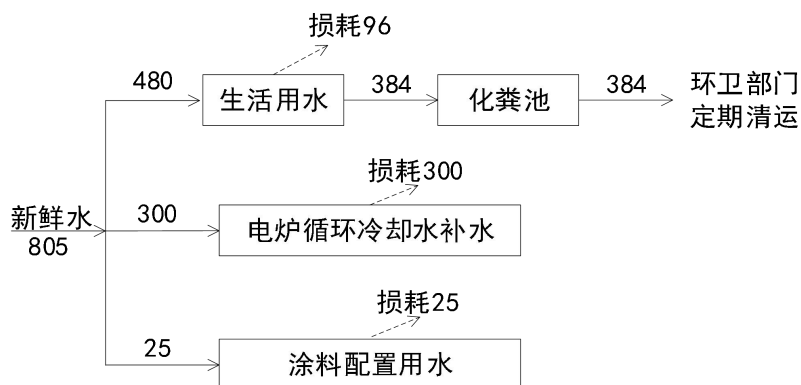
图 2-1 项目全厂水平衡图（单位：m³/a）
