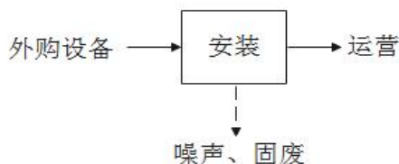
图 2-2 施工期工艺流程及产污情况图
