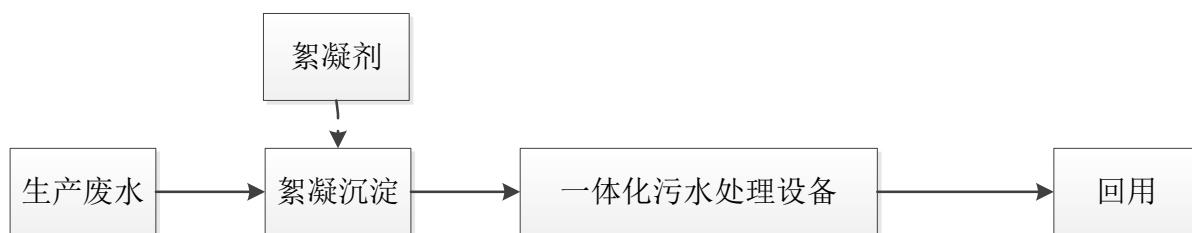
图 4-1 厂区污水处理站工艺流程图
