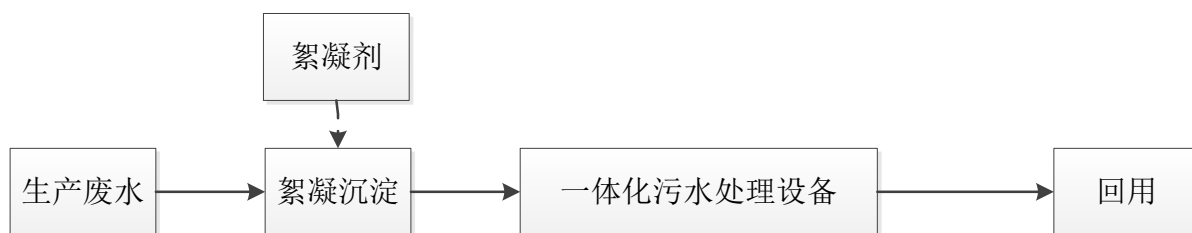
图 4-1 厂区污水处理站工艺流程图
