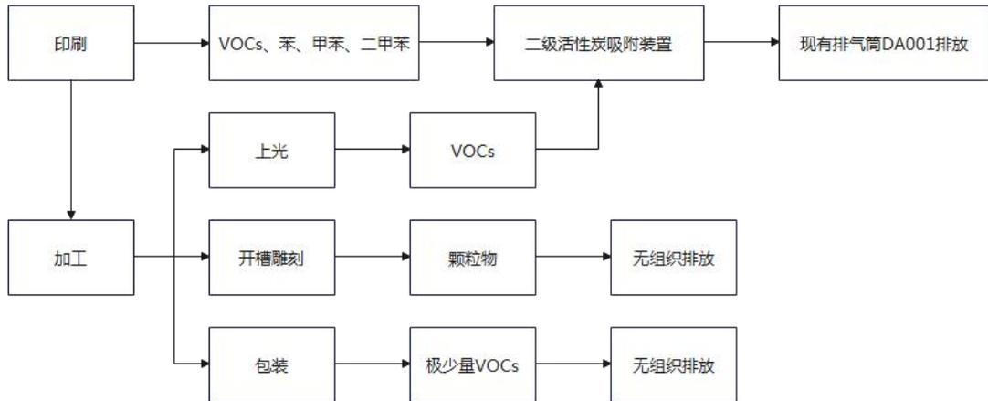
图 2-2 项目废气处理工艺流程及产污节点图
