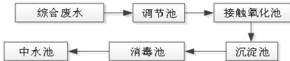
图 4-1 一体化污水处理设备处理工艺流程图
