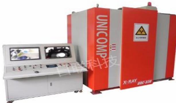
图 7-1 项目 X 射线数字成像检测设备示意图
