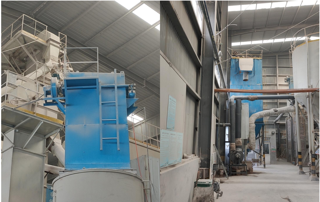
图 6-4 陶瓷模用石膏粉项目除尘设备
